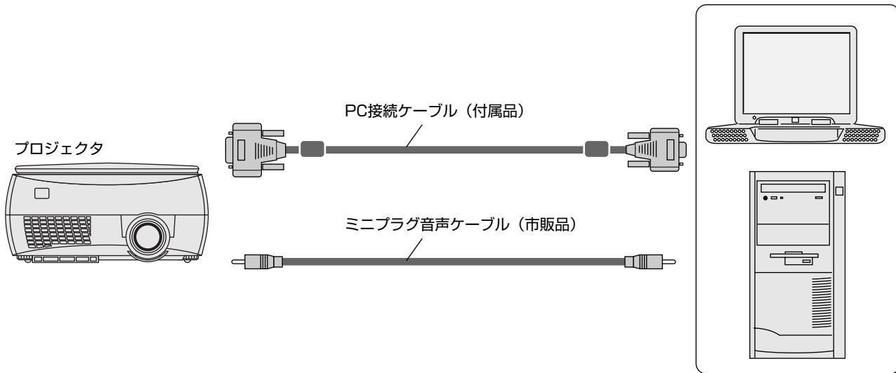
**お知らせ** ● PC 接続ケーブルを接続してから、パソコン側で、外部出力とパソコンの画面表示を設定してください。
