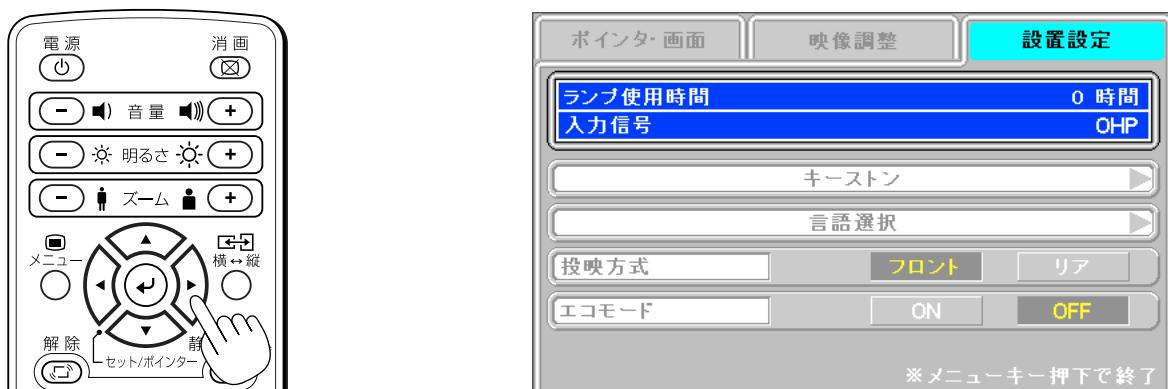
スクロール▶ボタンを押すごとに【ポインタ・画面】→【映像調整】→【設置設定】の方向へメニューが切り換わり、スクロール◀ボタンを押すごとに逆方向へ戻ります。
