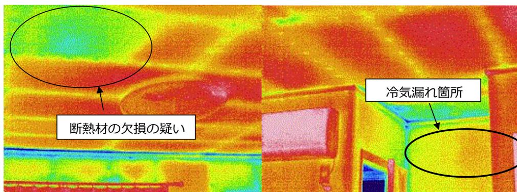
断熱材欠損があると冷暖房に使用するエネルギーロスが大きくなります。
