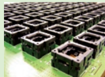
パーソンテストボード (ソケット面)
