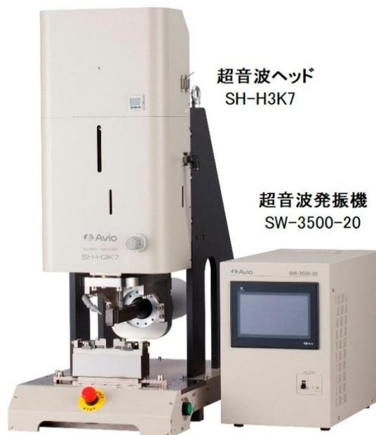
日本アビオニクス株式会社(本社:東京都品川区、社長:秋津 勝彦)はエコカーの需要増加に伴い軽量化・エレクトロニクス化が加速する自動車向けのハーネス、二次電池、モータなどの製造において銅やアルミ等の金属材料を超音波振動により溶接する【超音波金属溶接機 SW-3500-20/SH-H3K7】を本日より発売いたします。
