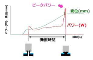
ピークパワーを自動制御 (ボスを押し潰し切ると超音波振動に対する負荷抵抗が増大し、パワー(W)が急激に増加。所定のパワーに到達したら発振停止する制御) することで安定したかしめ品質を得ることができます
