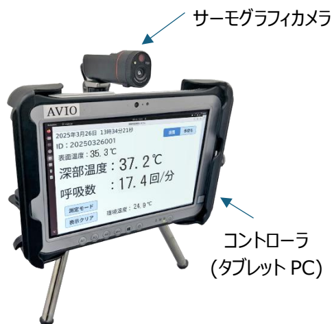
写真 1. 当社の医用サーモグラフィ技術を応用して開発したプロトタイプ（試作機）
