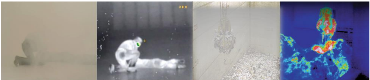
火災で室内やピット内に煙が充満しても、サーモカメラなら現場の状況を鮮明な画像で確認できます
