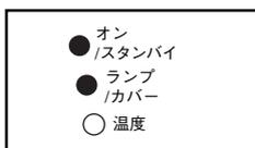
電源ボタンを押します。ファンが回転し、ランプが点灯し、オン/スタンバイLEDが緑色に点灯します。ランプ/カバーLEDが緑色に点灯します。
